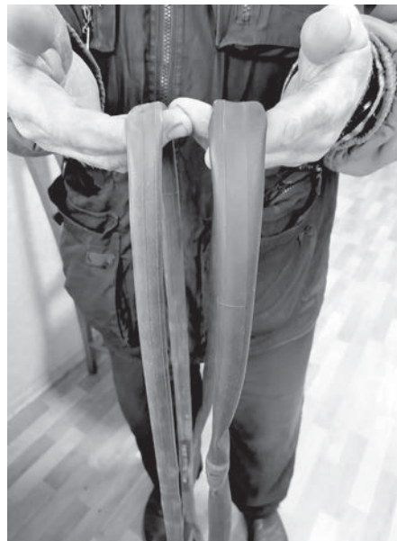
Размер установленной камеры (слева) явно не соответствует «родной».
